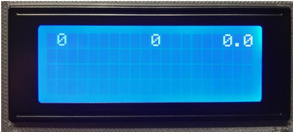
Nach dem Einschalten (oder der Betätigung der Taste "C") befindet sich das Gerät im Modus zur Trefferauswertung (Grundbildschirm). In Zeile 1 werden links die Anzahl der erfassten Schüsse angezeigt, in der Mitte die Summe der mit diesen Schüssen erzielten Ringe und rechts der sich daraus ergebende Durchschnitt. In den Zeilen 2-4 werden die Trefferzahlen pro Ringwert an fixen Positionen eingeblendet (wenn ungleich bzw. größer 0).
