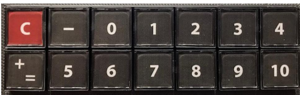
Die Tastatur besteht aus 14 Tasten mit dem hier gezeigten Tastaturlayout wie. Die Taste "C" (für "Clear") ist immer aktiv und setzt das Gerät immer in den Modus der Treffererfassung mit 0 erfassten Treffern zurück.
