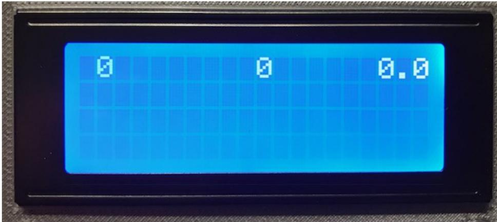
Dies ist der Startbildschirm für die Treffererfassung. Wie oben schon erwähnt, werden in der ersten Zeile links die Anzahl der erfassten Schüsse angezeigt, in der Mitte die Summe der erfassten Ringe und rechts der sich daraus ergebende Durchschnitt. Mit der Taste "C" werden alle erfassten Treffer gelöscht und wieder dieser Bildschirm angezeigt.
