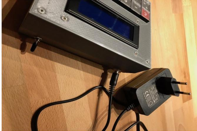
Der Additron 7000 benötigt für den Betrieb lediglich den Anschluss des 9V Steckernetzteils. Die Buchse hierfür befindet sich hinten links (hier kann man schlecht etwas falsch machen).
